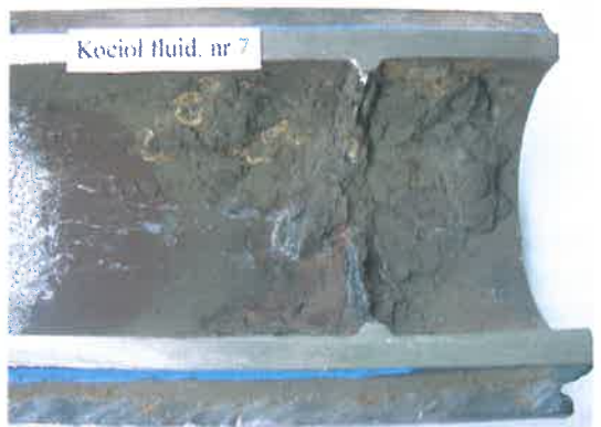
Rys. 1–4. Przykłady stanu rur ekranowych porażonych korozją z kotłów pracujących w elektrociepłowniach
