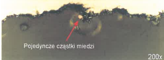
Rys. 5 i 6. Osady na powierzchni rur po chemicznym oczyszczeniu
