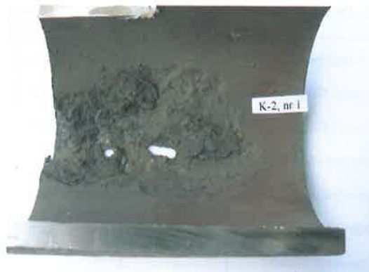
Rys. 1–4. Przykłady stanu rur ekranowych porażonych korozją z kotłów pracujących w elektrociepłowniach
