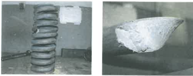
Rys. 6. Złamana sprężyna po demontażu z wieszaka zamocowania
