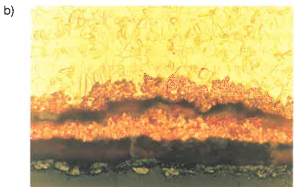
Rys. 4. Odcynkowanie powierzchni a) zewnętrznej, b) wewnętrznej
