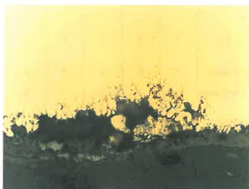
Rys. 5. Korozja międzykrystaliczna na powierzchni a) zewnętrznej, b) wewnętrznej
