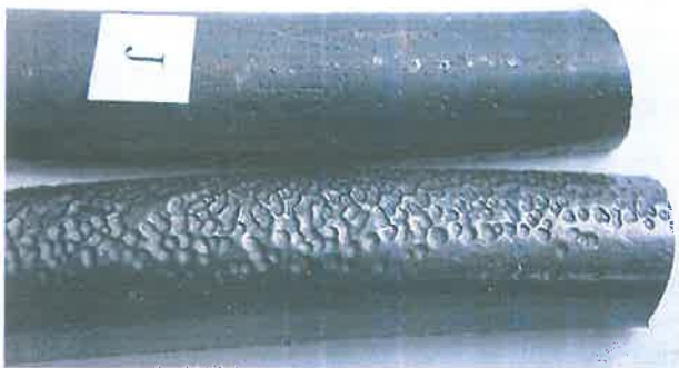
Rys. 10. Erozja czynnikiem (para grzewcza) na powierzchni zewnętrznej
