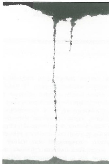
Rys. 4. Śródkrystaliczny charakter pęknięcia
