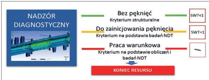
Rys. 8. Określanie zapasów trwałości elementów krytycznych urządzeń do pełnego wyczerpania ich trwałości z uwzględnieniem kontroli propagacji pęknięć (według kryteriów mechaniki pęknięcia)
