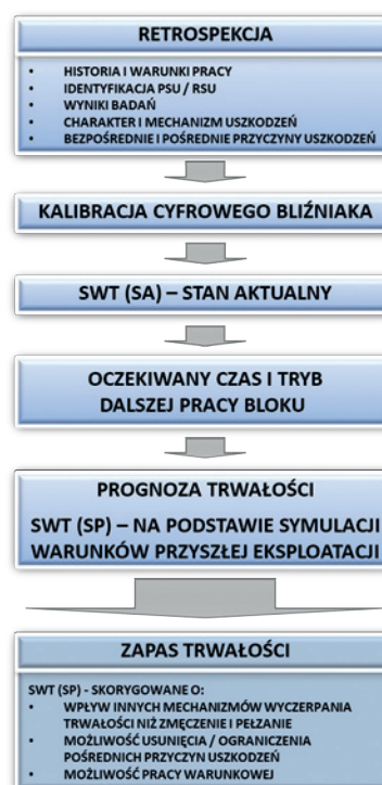
Rys. 16. Schemat procesu określania zapasów trwałości elementów krytycznych bloków/urządzeń energetycznych w przedłużonym czasie eksploatacji i dowolnym trybie pracy
