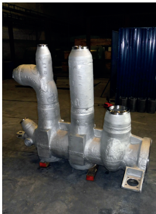
Rys. 14. Komora zaworowa po rewitalizacji
