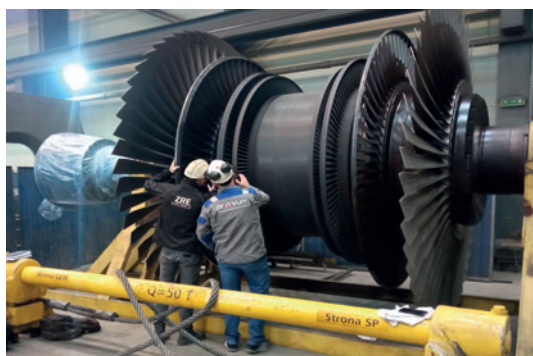
Rys. 1. Wirnik NP turbiny typu 200 MW w trakcie oględzin
