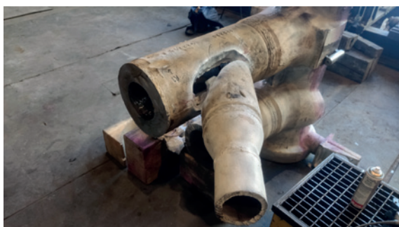
Rys. 13. Komora zaworowa w trakcie rewitalizacji
