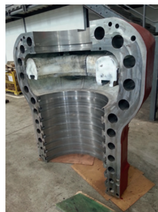
Rys. 7. Kadłub wewnętrzny turbiny typu 50 MW po remoncie i rewitalizacji
