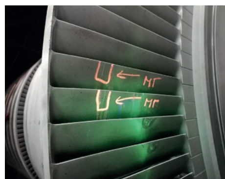
Rys. 9. Dwie z pękniętych łopatek, wynik badania magnetyczno-proszkowego
