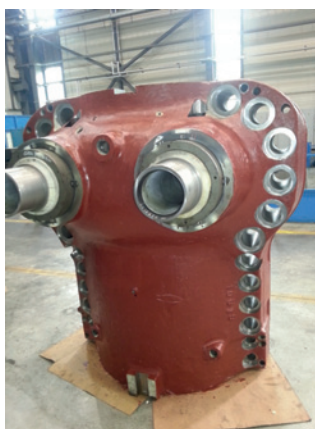
Rys. 6. Kadłub wewnętrzny turbiny typu 50 MW po remoncie i rewitalizacji
