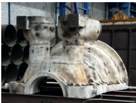
Rys. 2. Kadłub SP turbiny typu 200 MW przygotowywany do obróbki cieplnej
