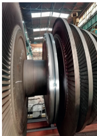
Rys. 13. Wirnik z odbudowanym wrębem
