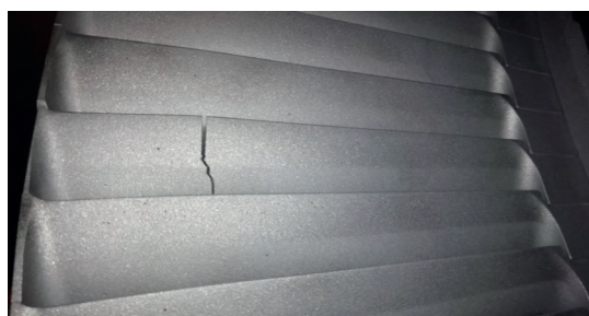
Rys. 10. Pęknięta łopaska, wynik badania wizualnego
