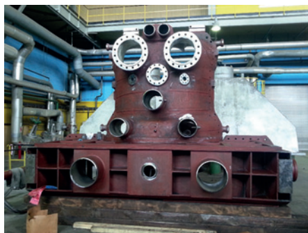
Rys. 3. Kadłub SP turbiny typu 200 MW po remoncie i rewitalizacji
