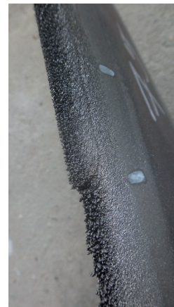
Rys. 4. Ubytki erozyjne na krawędziach łopatek
