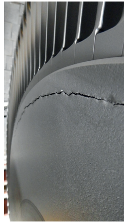
Rys. 2. Pęknięta tarcza wirnikowa turbiny typu 50 MW
