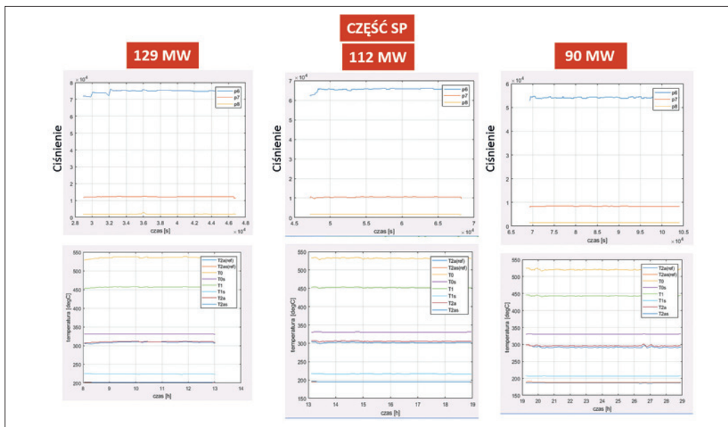
Rys. 5. Temperatury i ciśnienia dla części SP w punktach kontrolnych
