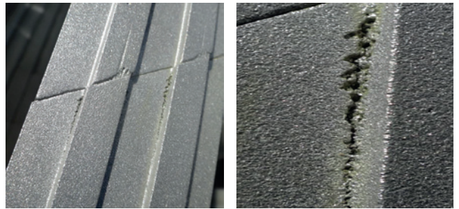
Rys. 9. Ubytki erozyjne w materiale bandaża
