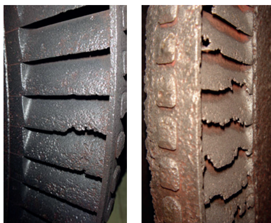
Rys. 12. Przykład korozji postojowej łopatek wirnikowych
