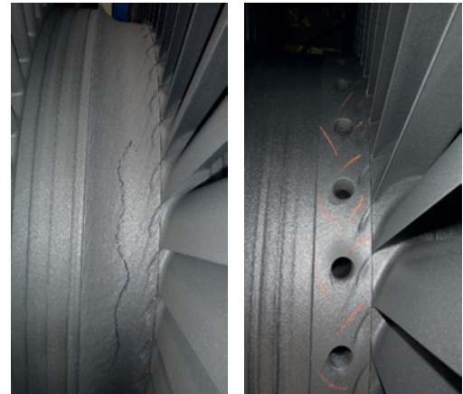
Rys. 10. Ubytki erozyjne na wale wirnika
