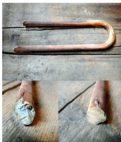
Rys. 7. Obejmy – zdjęcie obiektowe oraz zdemontowana obejma po awarii
