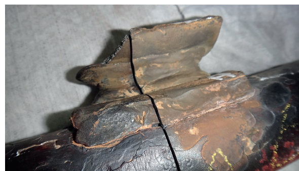
Rys. 11. Przejrzewacz pary wtórnej II st. (10CrMo9-10) – pęknięcie w SWC w obszarze spoiny zamocowania
