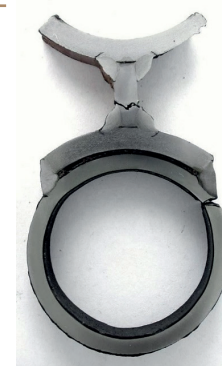
Rys. 11. Przejrzewacz pary wtórnej II st. (10CrMo9-10) – pęknięcie w SWC w obszarze spoiny zamocowania
