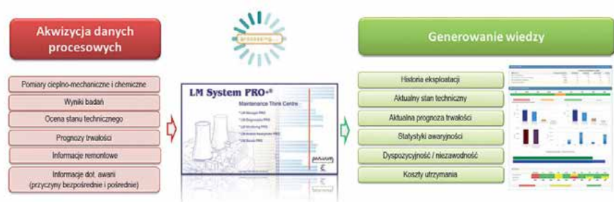
Rys. 1. Zdalna diagnostyka w formie wieloletniego serwisu LM Serwis PRO+® zapewniająca automatyczną aktualizację oceny stanu technicznego i prognozy trwałości, zrealizowana na Platformie LM System PRO+®.
