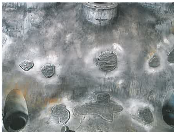
Stan powierzchni zewnętrznej części górnej kadłuba zewnętrznego WP turbiny 13K215 po spawaniu
