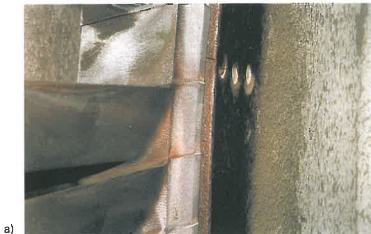
Pęknięcie obrzeża tarczy wirnikowej w okolicy zamka oraz wycięte pióro topatki zamkowej (nieskuteczna próba zapobiegnięcia rozwojowi pęknięcia)
