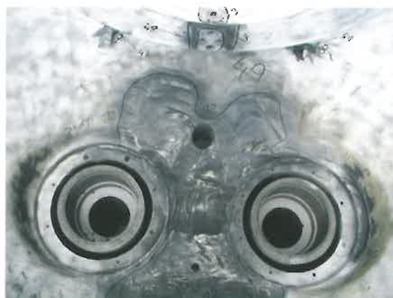
Stan powierzchni wewnętrznej kadłuba zewnętrznego WP turbiny 13K215 po usunięciu pęknięć
