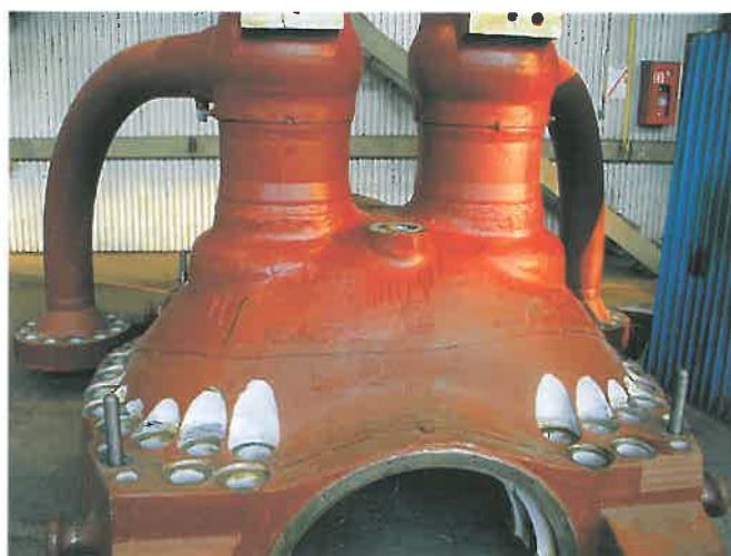
Kadłub zewnętrzny turbiny 13K215 po rewitalizacji przygotowany do transportu
