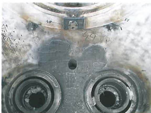
Stan powierzchni wewnętrznej kadłuba zewnętrznego WP turbiny 13K215 po naprawie przez spawanie
