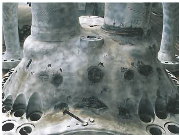
Stan powierzchni zewnętrznej części górnej kadłuba zewnętrznego WP turbiny 13K215 po usunięciu pęknięć
