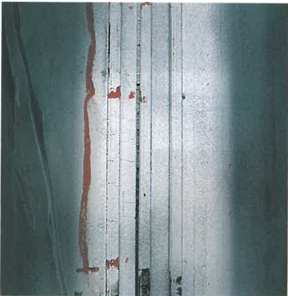
Pęknięcia ujawnione na powierzchni tarczy nasadzonej
