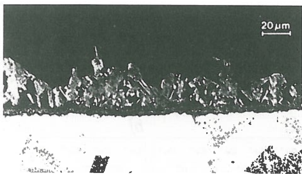
Rys. 1. Podwójna warstewka ochronna \text{Cu}_2\text{O}/\text{Cu}_2\text{O}-\text{CuO} na rurce skraplacza (materiał MC70)
