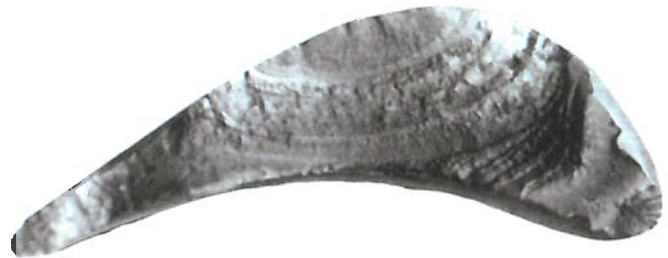
Rys. 3. Charakterystyczny złom łopatki wywołany korozją zmęczeniową
