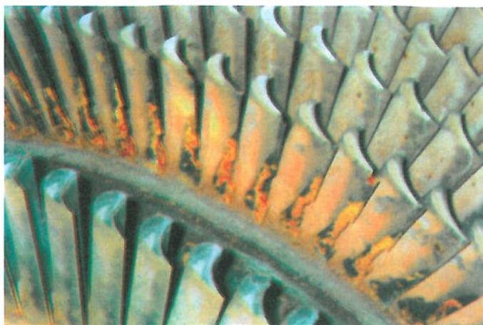
Rys. 5. Znaczne ubytki korozyjne na wylotowych krawędziach łopatek (czas pracy do powstania uszkodzenia kilkanaście dni)
