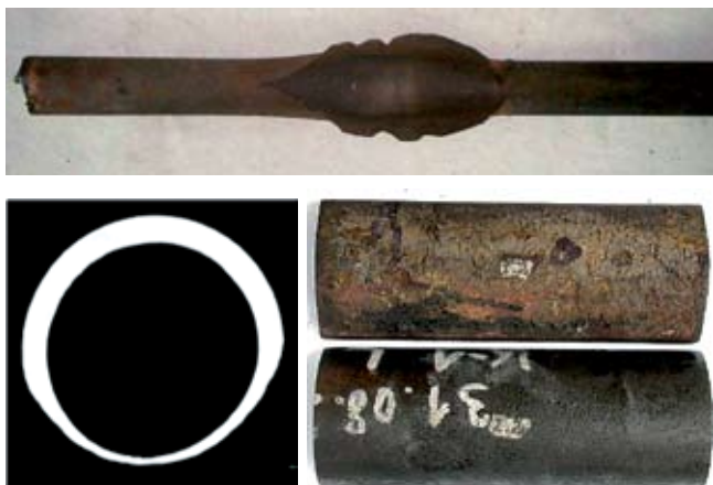
Rys. 14. Uszkodzona rura parownika
