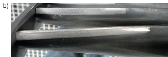
Rys. 44. Widok powierzchni (krawędzi natarcia) łopatek na wieńcu podczas rewizji po dwóch latach eksploatacji turbiny parowej TC 1201: a) łopatka bez powłoki – widoczne ślady zniszczenia w efekcie erozji; b) łopatki z napawaną laserowo powłoką ze stellite 6 – powierzchnia łopatki nie wykazuje większych śladów zużycia
