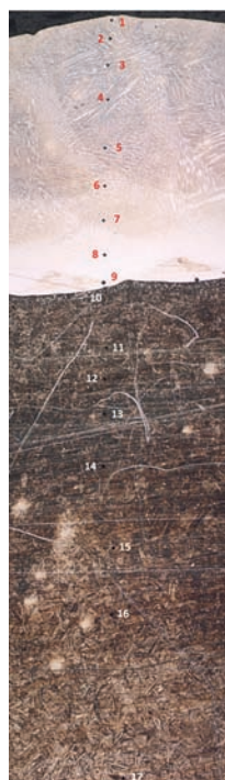
Rys. 42. Przykładowa mikrostruktura napawanej laserowo powłoki stellite 6 na powierzchni łopatki parowej z zastosowaniem międzywarstwy
