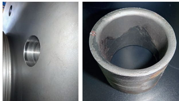
Rys. 6. Wycinki materiału do badań specjalnych z tarczy wirnikowej stopnia regulacyjnego wirnika WP
