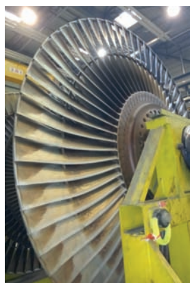
Rys. 10. Ubytki erozyjne na krawędziach wlotowych. Turbina 200 MW, wirnik NP
