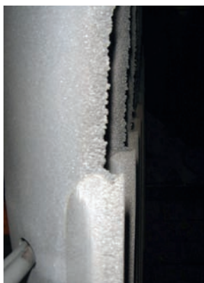
Rys. 7. Ubytki erozyjne na krawędziach wlotowych. Turbina 200 MW, wirnik NP
