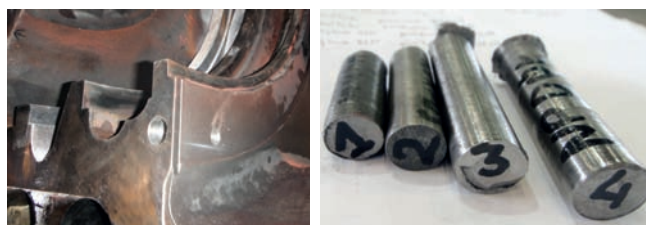
Rys. 7. Wycinki materiału do badań specjalnych wytrepanowane z kadłuba turbiny
