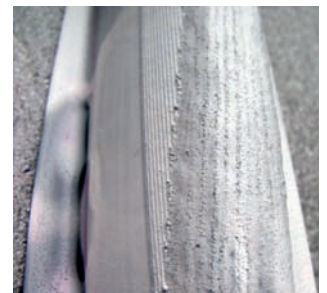
Rys. 40. Widok powierzchni łopatki po napawaniu w trakcie wykonywania kontroli na obecność ewentualnych pęknięć (badania penetracyjne) – brak pęknięć w napawanej laserowo warstwie
