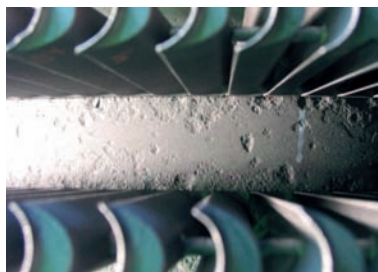
Rys. 27. Korozja postojowa. Turbina 100 MW, wirnik turbiny
