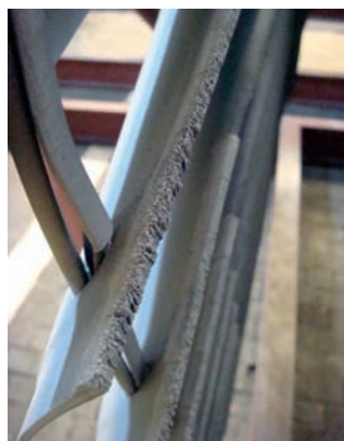
Rys. 8. Ubytki erozyjne na krawędziach wlotowych. Turbina 100 MW, wirnik NP
