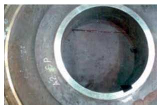
Rys. 44. Tarcza nasadzana wirnika 50 MW, po tulejowaniu
