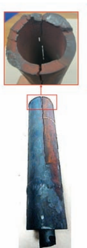
Rys. 4. Urwana lanca (w kształcie litery „L”) aparatu wtryskowego, w tle widoczna wyczystka komory schładzacza, o którą opiera się lanca
