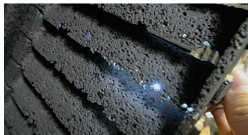
Rys. 28. Układ łopatkowy wirnika turbiny 30 MW porażony korozją postojową
