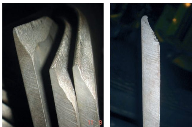
Rys. 2. Ubytki erozyjne na krawędzi wlotowej. Turbina 360 MW, wirnik NP
