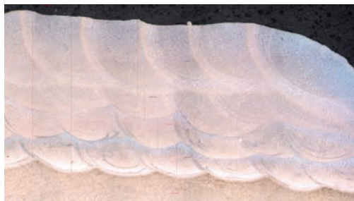
Rys. 41. Przykład mikrostruktury napawanej laserowo powłoki stellite 6 na powierzchni łopatki parowej – powierzchnia przed obróbką mechaniczną (zgodz. poprzeczny nietrawiony, LM)
