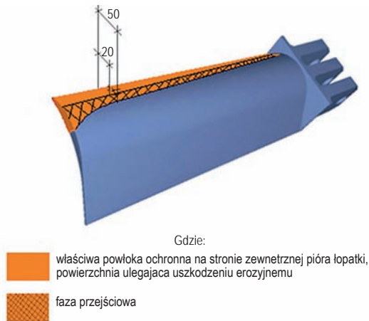
Rys. 38. Przykład zabezpieczenia łopatki turbiny energetycznej węglkową powłoką ochronną natrykiwaną ciepłnie przy zastosowaniu międzywarstwy
