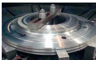
Rys. 43. Nowa tarcza nasadzana wirnika 30 MW, w czasie obróbki końcowej
