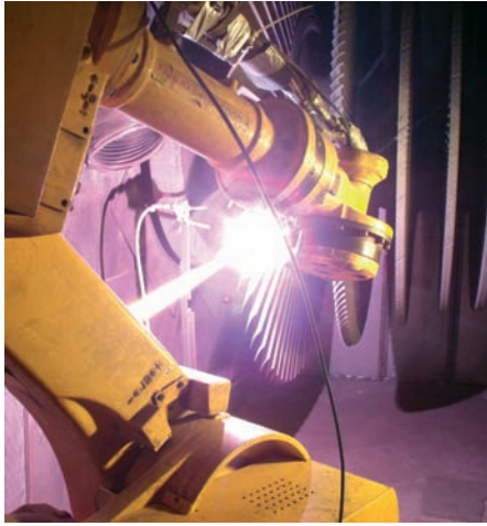
Rys. 36. Proces natryskiwania ciepłego powłok antyerozyjnych realizowany na wirniku turbiny parowej na łopatkach stopnia 5. wirnika NP turbiny TK-120
