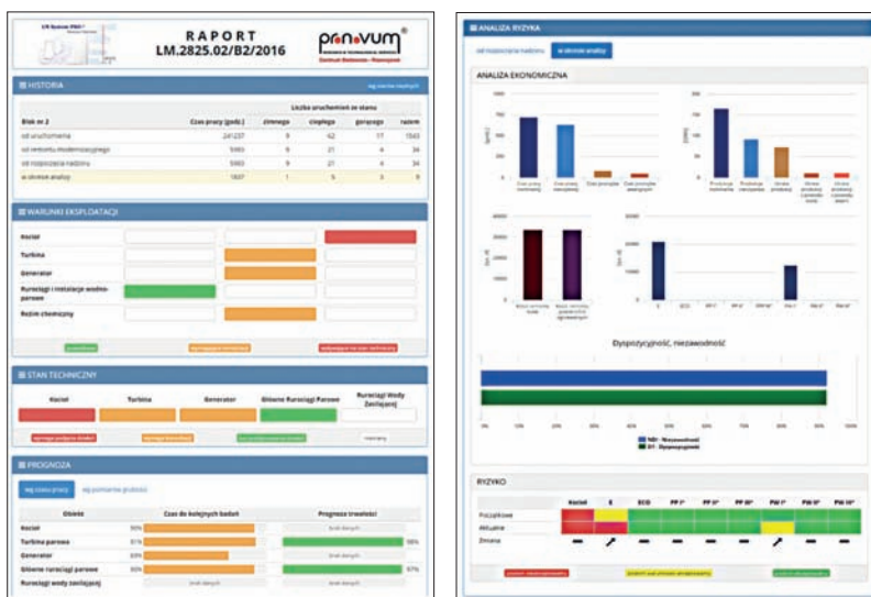
Rys. 3. Przykładowa, generowana automatycznie, część raportu serwisowego dla powierzchni ogrzewalnych kotła BB-1150
