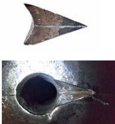
Rys. 1. Próbkki do badań niszczących: A, B – próbka łódkowa pobrana z krawędzi otworu, C – próbka trepanacyjna pobrana płaszcza walczaka
