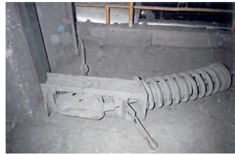
Rys. 2. Zerwane, na skutek uderzenia hydraulicznego, zamocowanie statositowe rurociągu pary do wtórnego przegrzewu bloku 120 MW
