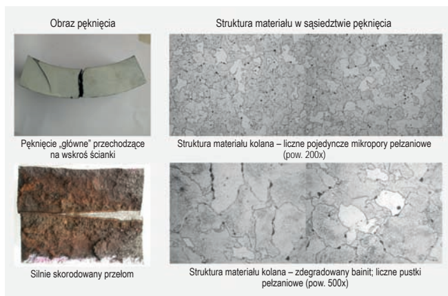
Rys. 18. Rzeczywiste miejsca występowania uszkodzeń o charakterze pełzaniowym
